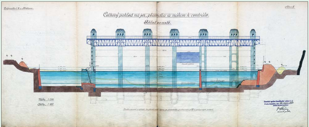
Obr. 71 Střekov, ideový pohled na jezovou konstrukci, 1922
