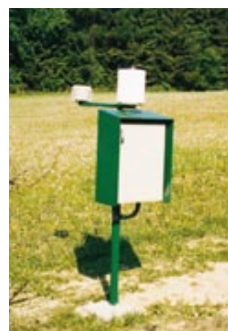
Srážkoměrná stanice s automatickým přenosem dat
