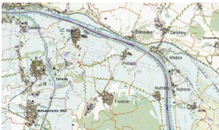
Ukázka zobrazení v GIS – zátopové území pro Q_{100} na Labi v Českých Kopestech
