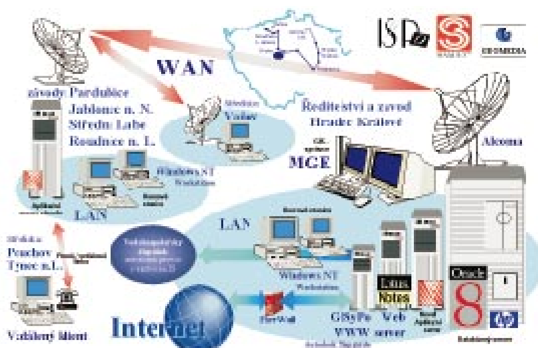
Schéma technického řešení informačního systému Povodí Labe
