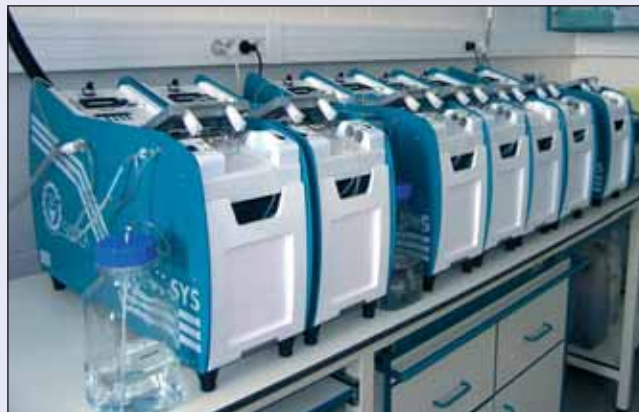
Laboratoř v Hradci Králové, průtokový analyzátor iontů
