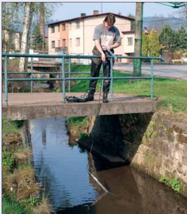
Měření kvality vody v terénu sondou
