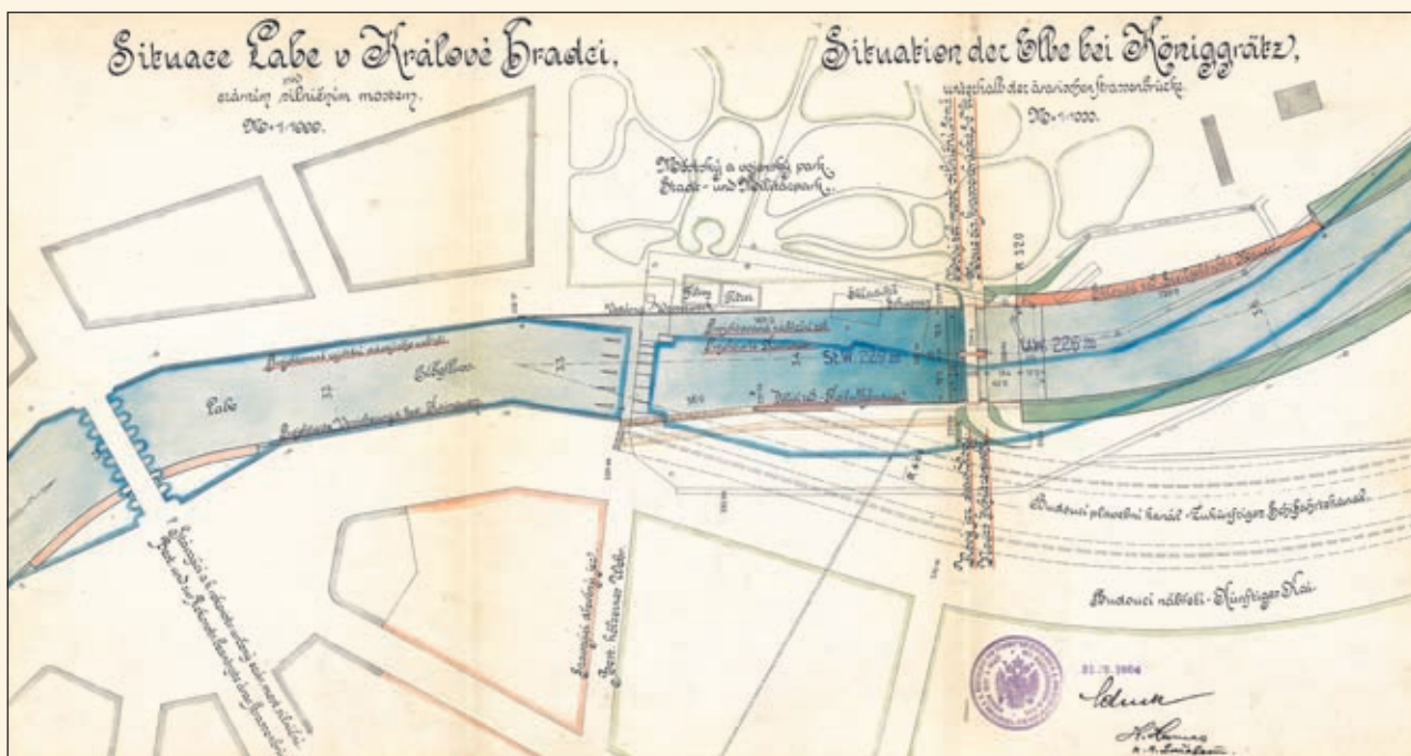
Obr. 85 Plánované umístění plavebního kanálu u jezu Hučák z roku 1904
