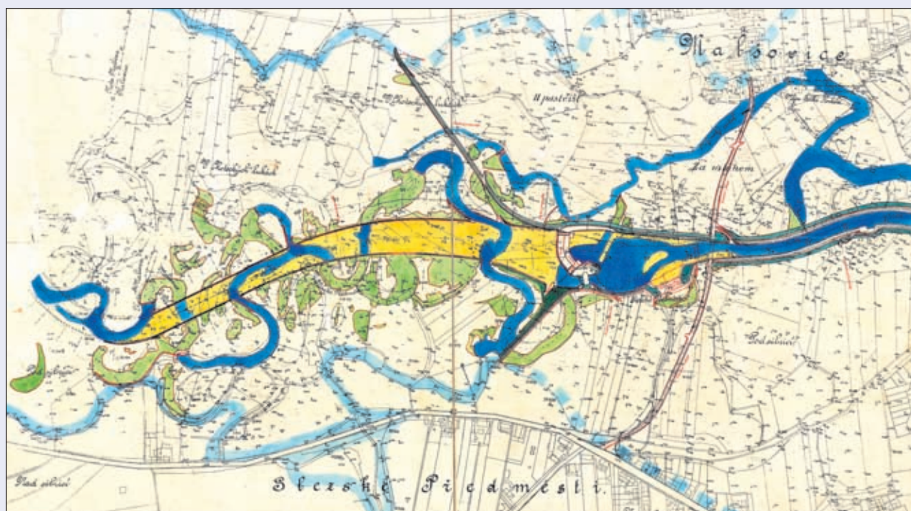
Obr. 64 Návrh úpravy Orlice nad Malšovickým jezem (1923)
