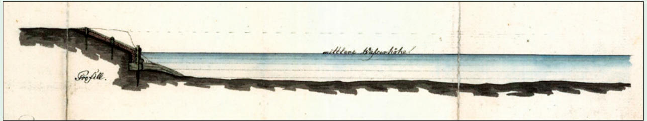
Obr. 10 Oprava břehu Orlice proutím a hatěmi (1880)
