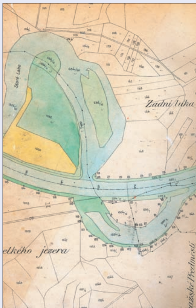
Obr. 46 Průpich meandrů U velkého jezera a Zadní luka ve Třebíši (1904)
