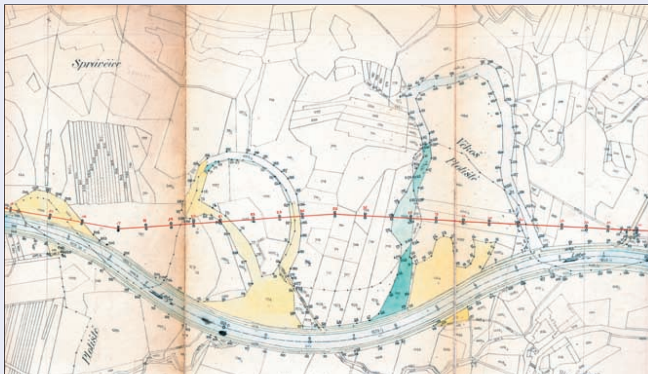
Obr. 50 Průpichy dvou meandrů na Labi u Správcic (1904)
