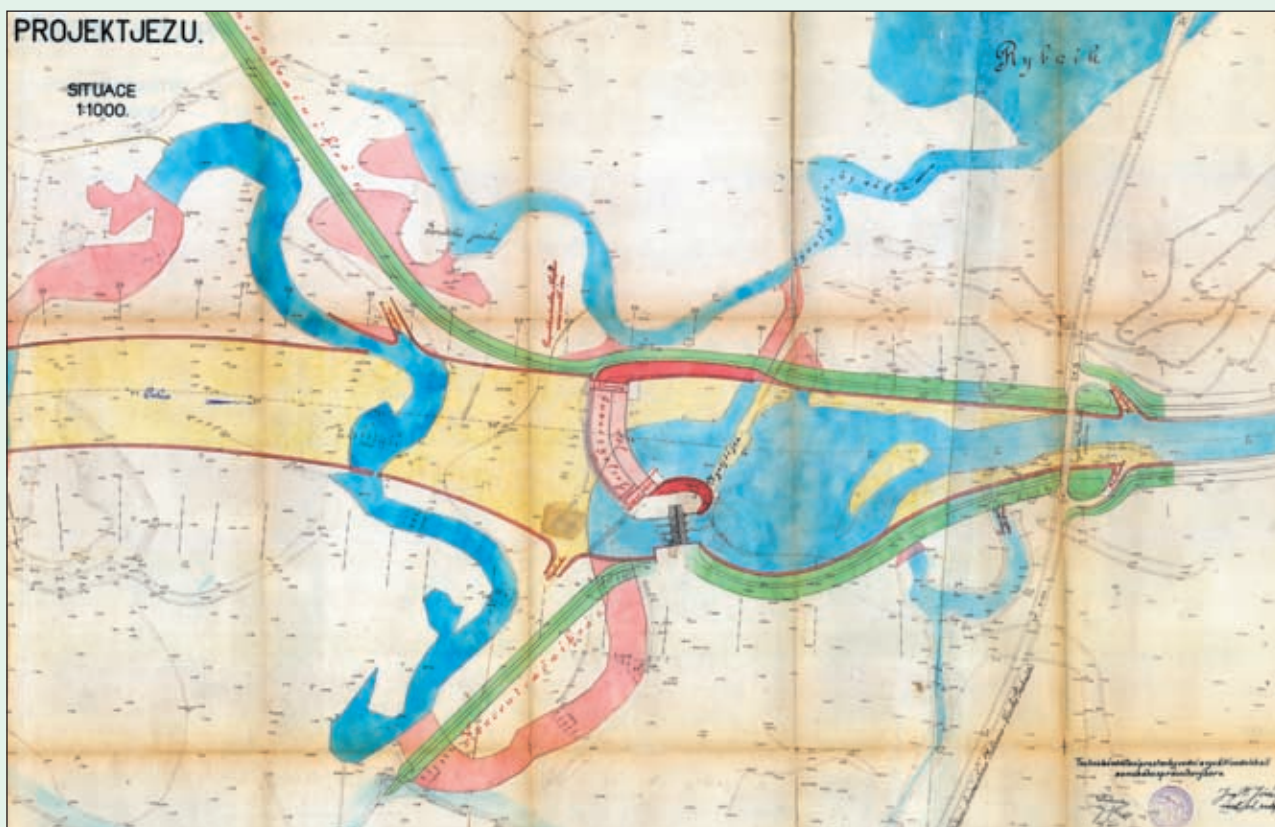
Obr. 89 Situace svodných hrází na Orlici (1923)
