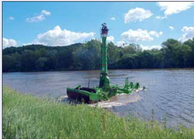
Podvodní dozer Komatsu na labské vodní cestě
