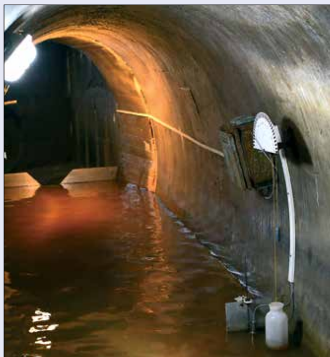
VD Josefův Důl, měření průsaků v odvodňovací stole
